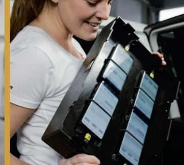
Jedes Drivetest-Fahrzeug transportierte neun Smartphones für die Sprach- und Datentests.
